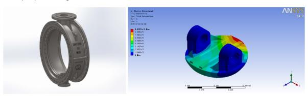
2、阀门结构采用偏心楔紧原理,通过传动机构达到楔紧、调节、关闭的目的,阀座密封面与阀瓣密封面均采用金属球面密封。关闭时阀瓣球面沿阀座渐进,具有剪切刮扫功能,能够有效地切除结垢障碍、刮扫固体颗粒,实现可靠密封。因此,旋球阀特别适用于含固体颗粒的介质输送。
