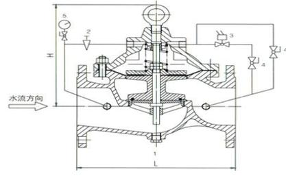
1-主阀 2-针阀 3-电磁阀 4-球阀 5-压力表
