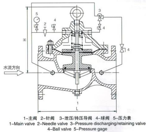
1-主阀 2-针阀 3-泄压/特压导阀 4-球阀 5-压力表
